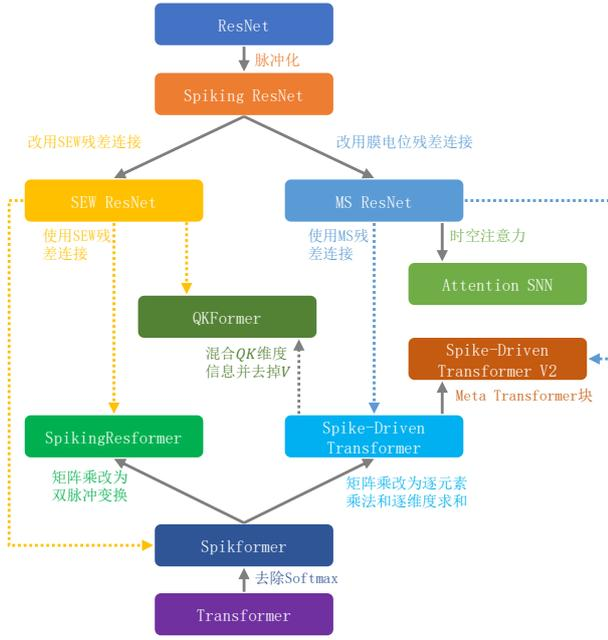
图5 部分网络结构改进研究的联系
