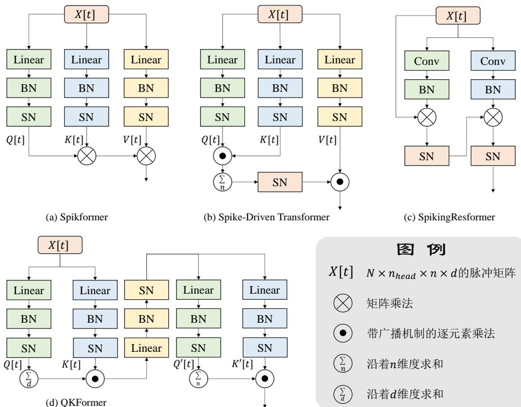
图 4 深度 SNN 中的自注意力机制
